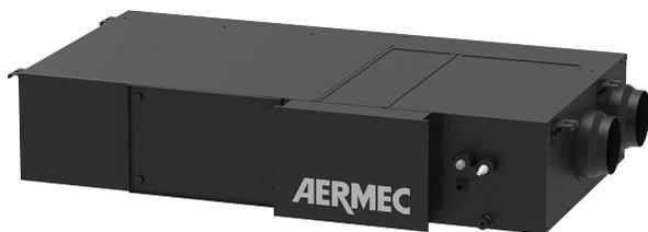
Die **Wärmerückgewinnungseinheiten** wurden für die horizontale Installation mit Kanalisierung in Innenräumen konzipiert. Sie sind mit einem Enthalpie-Gegenstromwärmetauscher mit einem Rückgewinnungswirkungsgrad von mehr als 70% ausgestattet. Der Wärmetauscher gestattet es, ohne eine direkte Vermischung der Luftvolumen Energie von der Fortluft auf die Frischluft zu übertragen.
