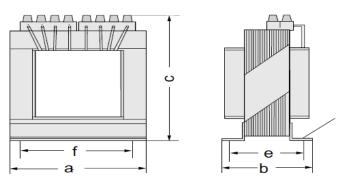
Nach VDE 0550 mit aufgebauter Klemmleiste, für Schaltschrankeinbau, für Drehstrom sind 2 Transformatoren erforderlich. (V-Schaltung) Die angegebenen Nennströme werden in einem ausreichend grossen oder einem belüfteten Gehäuse erreicht. Maximale Umgebungstemperatur +40°C.
