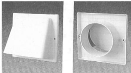
Überall dort empfehlenswert, wo Winddruck auf die Aussenwand auftreten kann. Die Aussenhaube fängt diesen ab, sodass die innen angebrachte einteilige Rückstauklappe sich in jeden Fall durch den Luftstrom öffnen kann. Zum einstecken in Lüftungsrohre oder zum direkten anschliessen von Lüftungsschläuchen.
