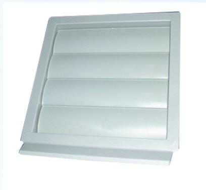
Für die Aussenwandmontage mit selbsttätig öffnenden und schliessenden Lamellen. Witterungs-Beständig (UV-stabil). Einsetzbar von  $-30\text{ }^{\circ}\text{C}$  bis  $+70\text{ }^{\circ}\text{C}$ . Druckverlust ca. 5–10 Pa. Dient gleichzeitig als Rückstauklappe für Rohr & Schlauch. Mit Anschlussstutzen.
