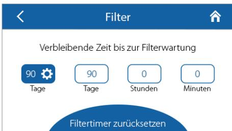
Einstellung des Filtertimers: Nach Ablauf eines voreingestellten Zeitraums (70 bis 365 Tage) wird auf der Startseite eine Warnung zum Filterwechsel angezeigt, während im Fenster **Alarme** die entsprechenden Informationen zum erforderlichen Filterwechsel angezeigt werden. Um den Filtertimer zu deaktivieren (z. B. wenn das Gerät mit Differenzdruckschaltern ausgestattet ist), stellen Sie den Wert auf 0 Tage ein.
