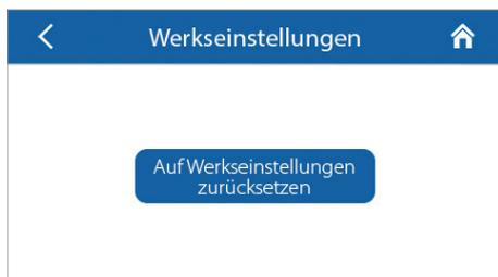
Das Zurücksetzen kann zu einem vorübergehenden Verbindungsverlust mit der Anlage führen, da die Einstellungen für Wi-Fi, RS-485 und Ethernet davon betroffen sind. Wiederholen Sie bei Bedarf die Einstellung von Wi-Fi, RS-485- und Ethernet-Parameter mithilfe der mobilen App (siehe Betriebsanleitung "Drahtloses Steuerungssystem").
