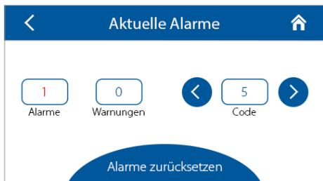
**0** : Anzahl der aktuellen Alarme. Weist auf einen schwerwiegenden Fehler im Betrieb hin. Die Lüftungsanlage wird zwangsweise ausgeschaltet. Die Alarme müssen manuell zurückgesetzt werden.
